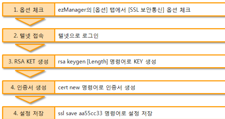
그림 7-6 TCP 서버일 때 SSL 보안통신 설정 절차
